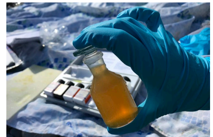
Figura 7: misurazione del contenuto di ossigeno. © Daria Lehmann / GLOBE Svizzera
