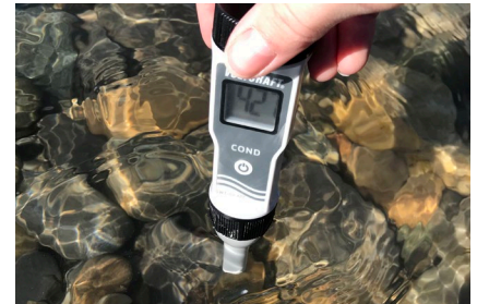
Figura 1: misurazione della conducibilità elettrica. © Daria Lehmann / GLOBE Svizzera
